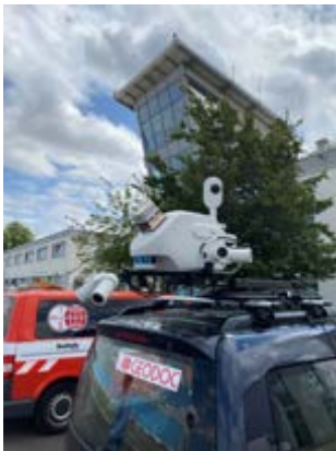
Bild: Leica Pegasus TRK System montiert auf Autodach
