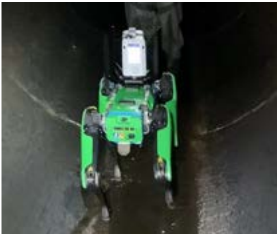
Bild: Spot von Boston Dynamics im Kanal.
