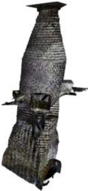
Bild: Punktwolke eines Schachtes
