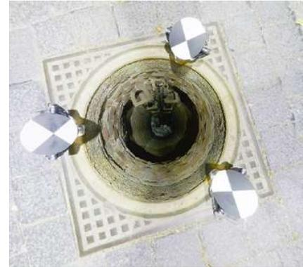
Abbildung 9: Leica Tilt &amp; Turn-Zielmarken am Schacht
