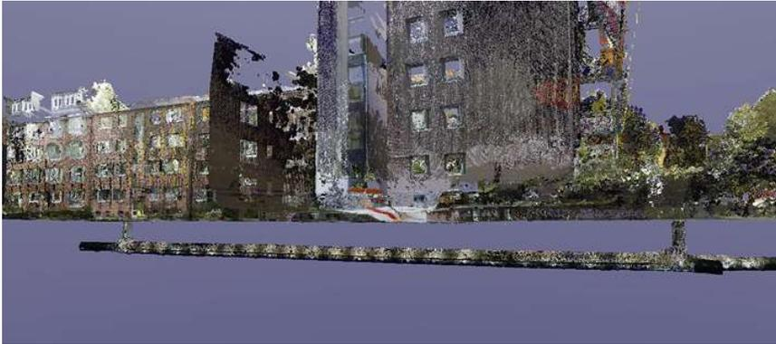
Abbildung 8: Eppendorfer Weg (HH), Eiprofil 1050 x 1750, seitliche Ansicht Kanal und Oberfläche
