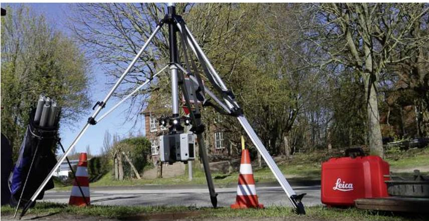
Abbildung 4: Schachtscan am Kurbelstativ
