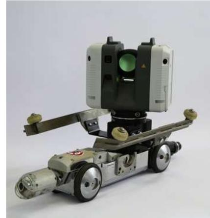
Abbildung 3: 3D-Scanner mit Fahrwagen IBAK T76
